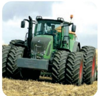
Одной из основных функций систем сдвоенных колес является увеличение тягового усилия трактора при выполнении тяжелых работ за счет увеличения площади сцепления колес с почвой и, одновременно, снижение давления на почву.
