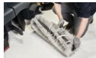
Легкий демонтаж/очистка щетки
